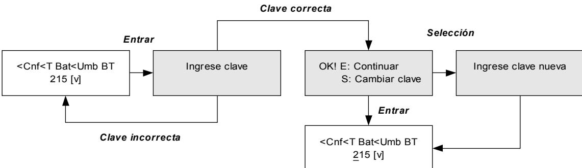
El equipo sale de fábrica con una clave por defecto igual a cuatro espacios en blanco “ ”. Una vez introducida la clave correcta, podrá editar todos los parámetros configurables sin que el equipo le vuelva a pedir la clave de acceso. La edición de la clave de acceso se efectúa como fue indicado al final de la [sección 5 – Sistema de menú](#).
