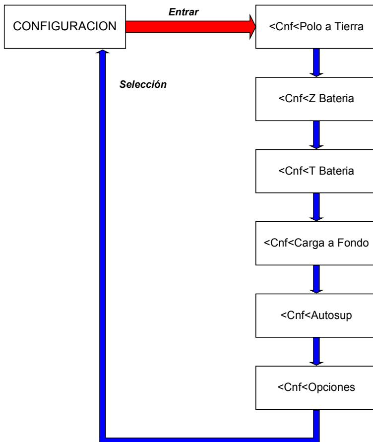
Este menú está protegido mediante clave de acceso de cuatro caracteres. Es posible visualizar todos los parámetros configurados, pero la edición de estos solo se realiza si la clave introducida es la correcta. Caso contrario, no será posible cambiar la configuración del **MB04**.
