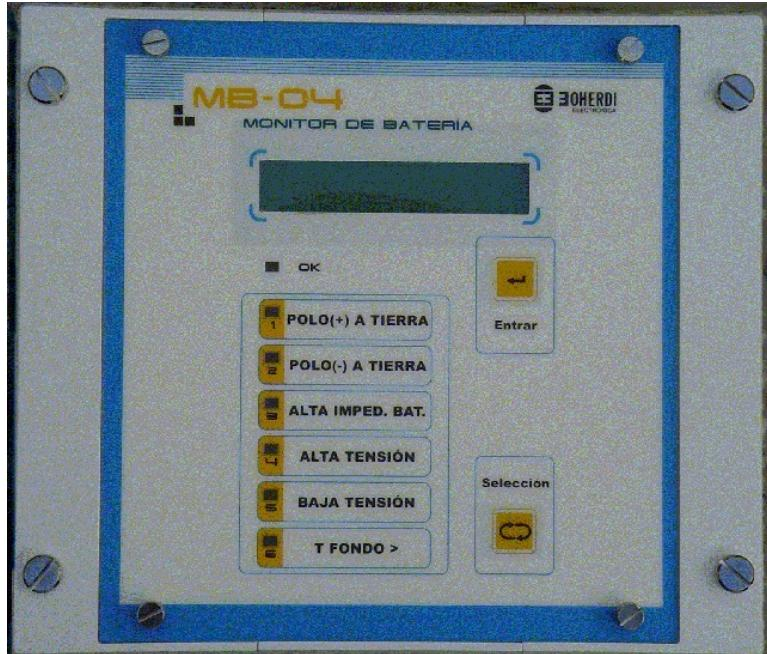
En la figura se muestra el frente del equipo, en la cual se pueden observar la ubicación de los pulsadores y demás elementos de anunciaci n.
